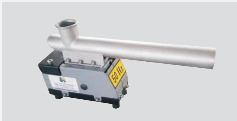
FZW振动器是一种微型的电磁驱动单元，具有良好的控制线性加上特殊板簧的超强恢复性，可实现高精度称量输送。
