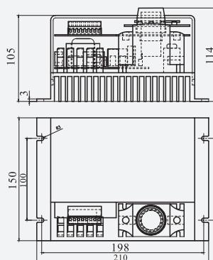
AB振动给料机配有标准控制系统，通过调节给料机料槽的振动幅度来控制给料机的物料流量。
