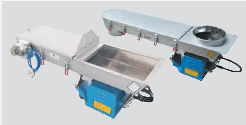
FZL系列电磁振动给料机是采用碳纤维板簧的新型设备，与传统给料机设备相比，具有结构紧凑、重量轻、工作平稳、噪音小、能耗低、安调及维修方便。驱动全身密封可水洗等优点。
